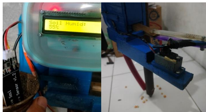
Gambar 114. Tampilan Alat Saat Pengujian Sensor dan Servo
