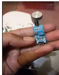
Gambar 13. Sensor IR Flame (Sumber : Data Peneliti 2025)
