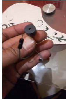
Gambar 16. Komponen Buzzer (Sumber: Data peneliti 2025)
